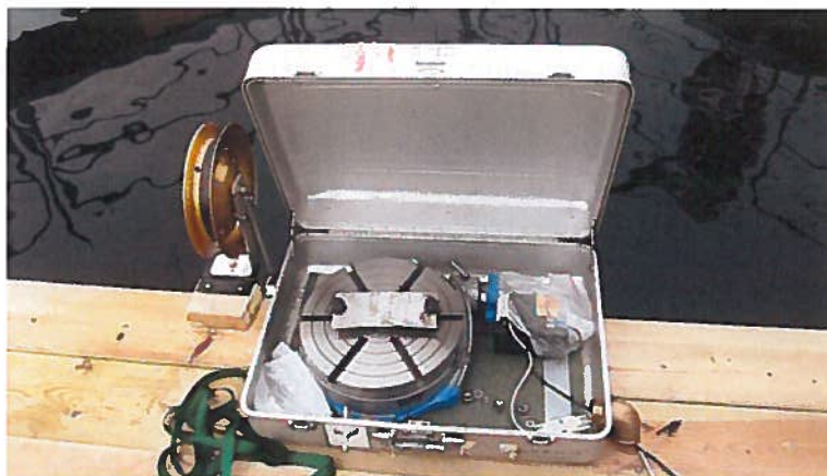
Fig. 10. Motor med steppermotor for rotasjon av målerigg.
